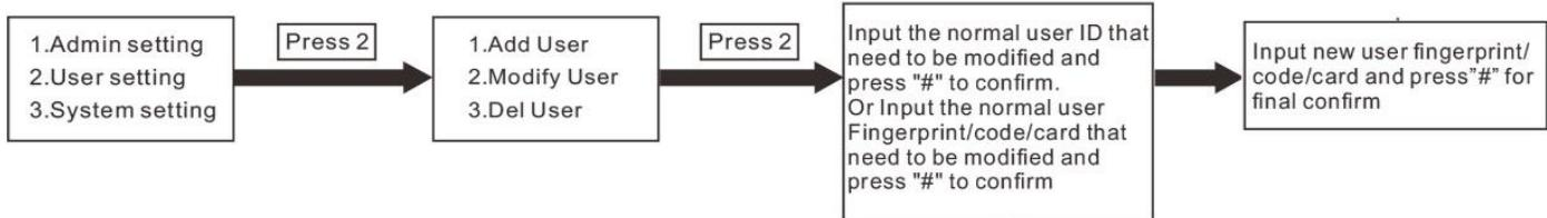
۶/۳) برای حذف کاربران قبلی ، پس از وارد شدن به منوی آن مطابق شکل ذیل ، روش پاک کردن کاربر را مشخص نمایید .
